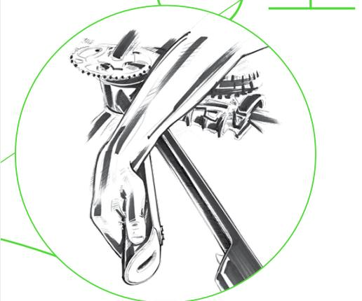
Evation elektrisiert sportliche Freizeitbiker durch einen in den Rahmen integrierbaren Antriebspack – eine kompakte Antriebsinheit mit Motor, Elektronik und Akku. Das Getriebe sitzt gut versteckt im Kurbellager und wiegt weniger als 1kg. Der Akkustand wird über ein Display am Lenker abgelesen. 2015 sollen die ersten Antriebe verfügbar sein, 2016 sind dann komplette Bikes im Handel.
